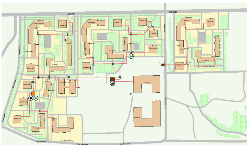
Рисунок Ошибка: источник перекрестной ссылки не найден.5– Изображение тепловой сети на карте с привязкой к местности.
